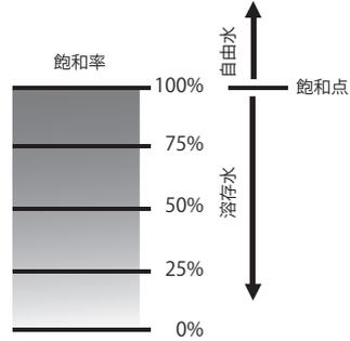
TWSシリーズは、オンライン設置で飽和水分・液温を常時モニタリング可能なセンサーで、鉱物油（作動油・潤滑油等）やエステル油にご使用いただけます。油種・油温にも依りますが、1,000~1,500ppmで飽和点を超え、自由水となって分離・乳化が起こり機械設備に影響を与える為、状態監視を行い未然に防止することが求められます。
