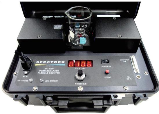
SPECTREX社製パーティクルカウンターは、1mLあたり1,000個以下の清浄度の高い液体の微粒子測定に適しており、最大の特徴はビーカーのまま測定する点にあります。
