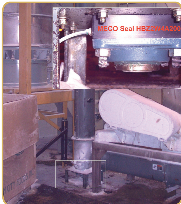
砂糖の垂直スクリーに設置された2" H Bシール 括弧内はシール部の拡大写真（HBZ2W4A200）
