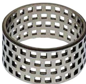
小さな角穴を多数の配列したステーターで、ローターとのクリアランスも小さく、最も高い剪断力を持ちます。溶解性の有無にかかわらず、結晶固体の高速分解に威力を発揮します。乳化、コロイド状懸濁液の予備分散にも適しています。
