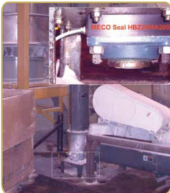
砂糖の垂直スクリーに設置された2"HBシール 括弧内はシール部の拡大写真（HBZ2W4A200）
