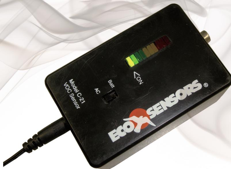
携帯型ハンディーVOCモニター・モデル:C-21は、ドライクリーニング業、塗装業、印刷業、木工加工業、病院、車修理業、化学薬品製造業、その他屋内作業で空気環境をモニタリングしなければならない場所で使用する、手のひらサイズの小型VOC(揮発性有機化合物)検知モニターです。
